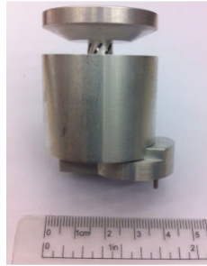
Şekil 5. Dairesel polarize yönsüz dalga kılavuzu yarıklı dizi anten
