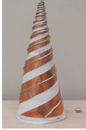
Şekil 2 Tasarlanan Konik Log Spiral antenin fiziksel görüntüsü
